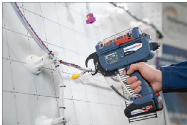
Autotool CPK Hybrid mit Akku und Kabelbinderkette.
