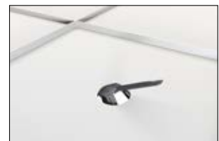
1. Einsetzen des Abstandshalters durch die Montageöffnung.
