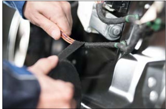
HelaTape Protect 250 bietet als Wickelband eine sehr hohe Temperaturbeständigkeit.
