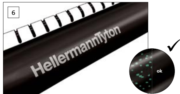
6 Die thermochromatischen Punkte (TCP) auf der Außenseite der Kabelreparaturmanschette dienen als Indikator für einen optimalen Schrumpfprozess, da sie bei ausreichender Hitzezufuhr verschwinden.
