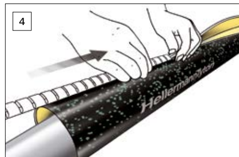
4 Wickeln Sie die Kabelreparaturmanschette um das beschädigte Kabel und positionieren Sie diese mit der Verschluss-Schiene.
