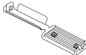
Befestigung wahlweise mit Acrylat-Klebeband oder M3-Schrauben
