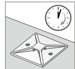
1. Die Oberflächen müssen trocken, frei von Staub, Öl, Oxiden, Trennmitteln und anderen Verunreinigungen sein. Die zu verklebende Oberfläche ist mit einem sauberen Tuch und Isopropanol / Wasser (50/50) zu reinigen. Bei Verwendung anderer geeigneter Reinigungsmittel ist darauf zu achten, dass die Oberfläche nicht angegriffen wird und keine Rückstände hinterlassen werden. Nach der Reinigung die Oberfläche unbedingt an der Luft vollständig trocknen lassen.
