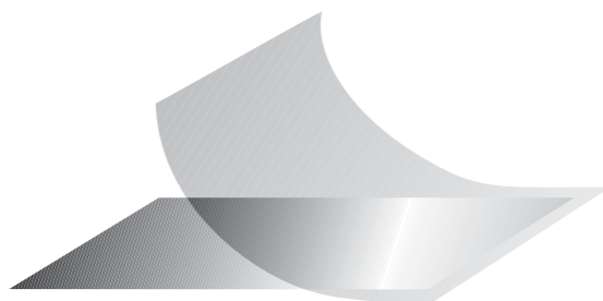
Das bedruckte silberne Typenschild wird mit dem transparenten Laminat geschützt.
