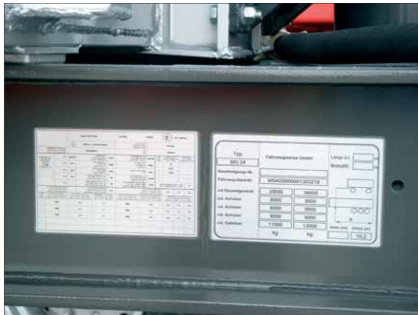
Typenschild eines LKW-Aufliegers mit Schutzlaminat.
