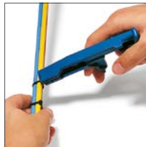
Abschneiden durch Drehen des Werkzeuges.
