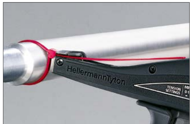
1. Spannen (Tension): Der Kabelbinder wird wie gewohnt gespannt.
