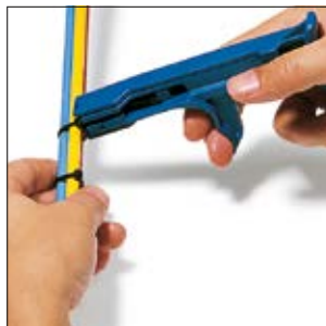
Werkzeug ansetzen, Kabelbinder spannen.
