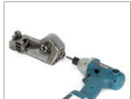
Das AMTS-Set beinhaltet das Verarbeitungswerkzeug und einen elektrischen Schraubendreher.
