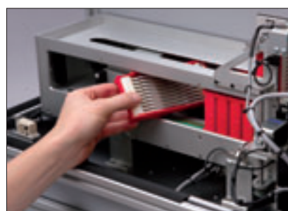
Einfaches Bestücken und Entnehmen der Kassette aus dem Prägeautomaten.
